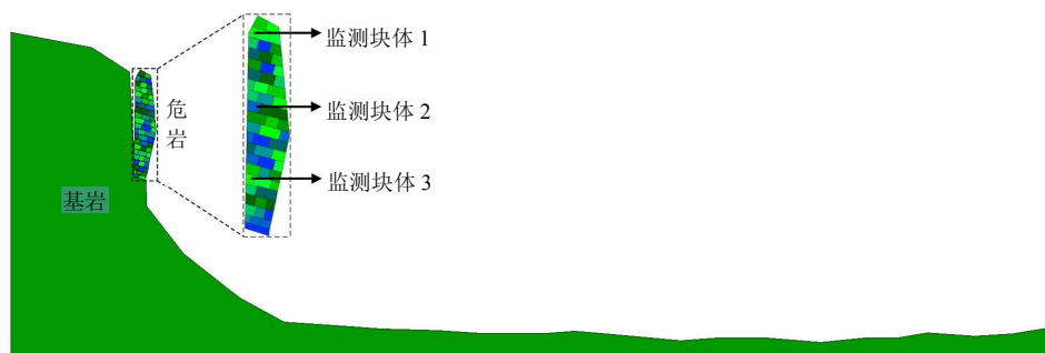
图2 概念危岩 DDA 计算模型
